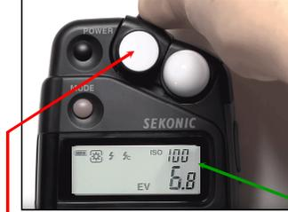
Con il diffusore piatto diventa un luxometro, ovvero un misuratore di illuminamento (quanti lumen a metro² arrivano)
