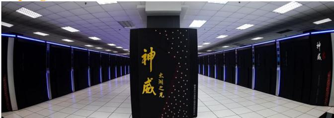
Tutti questi armadi servono per contenere **10,65 milioni di core**. Il supercomputer più potente in Italia è un **HPC2** della IBM usato dall'ENI, ha **72.000 core**, fa **3 TFLOPS**, è Linux (come il 96,4% dei Sc). Sono usati per calcoli su molti dati, come previsioni meteorologiche, simulazioni di processi fisici, calcolo delle rotte dei satelliti, applicazioni militari.
