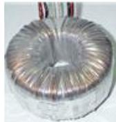
Trasformatore toroidale 220V 50VA 2x30V per dare 26V in ingresso (e 24V in uscita visto che 2V si fermano sul VR1)
