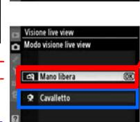
Non si può usare la D300 in Live view per più di un'ora perché il sensore si surriscalda e interviene una protezione che conta a rovescio gli ultimi 30 secondi prima che vada in protezione, ma è meglio fare pause ogni 30 minuti.
